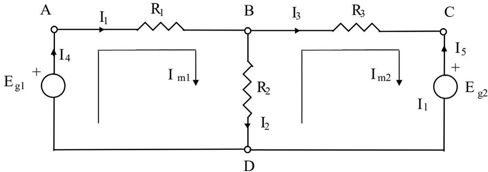
Figura 2. Circuito ejemplo para la resolución por mallas.
